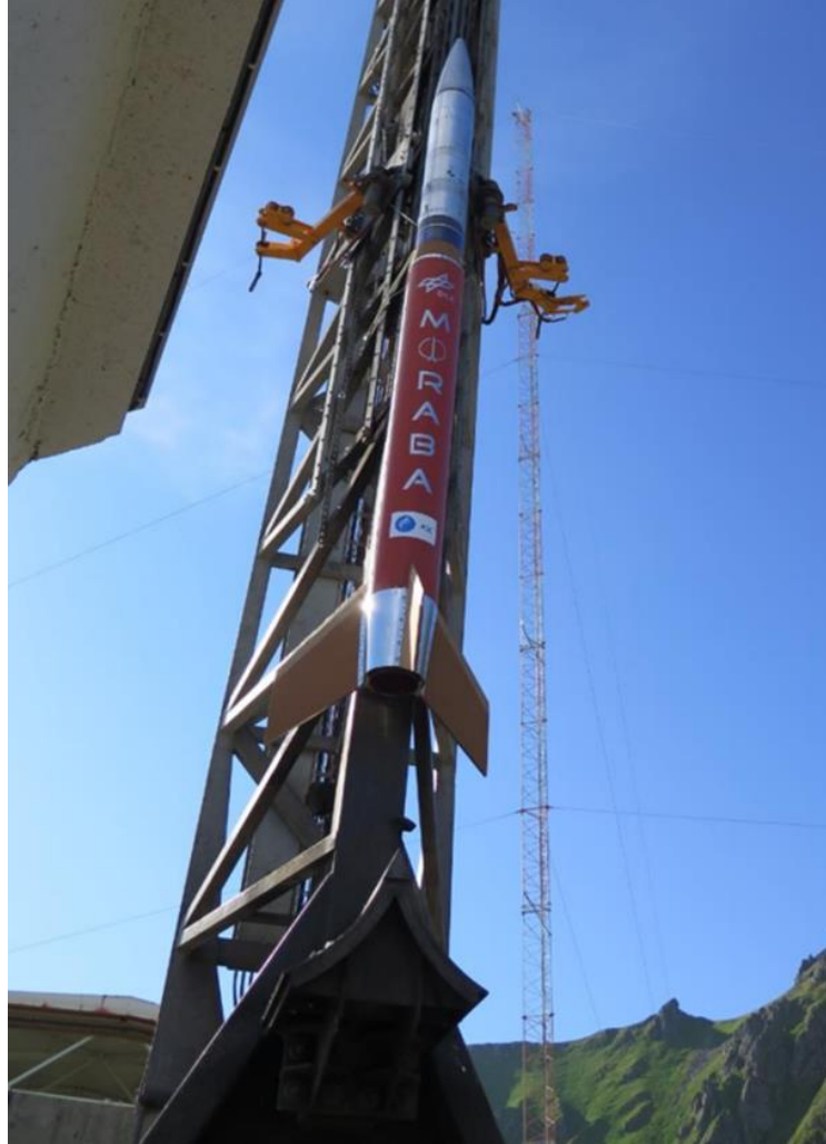
Şekil 5.7 Kanatçık üzerinde mantar tabanlı TPS ile Geliştirilmiş Malemute (IM) aracı [43].
