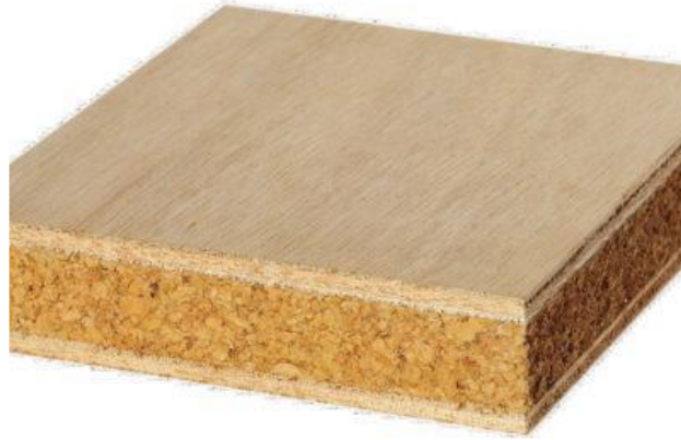
Şekil 4.9. Sandviç yapılı bir panel mantar malzeme ile doldurulur ve ahşap katmanlar her iki dış tarafa yapıştırılır [22].
