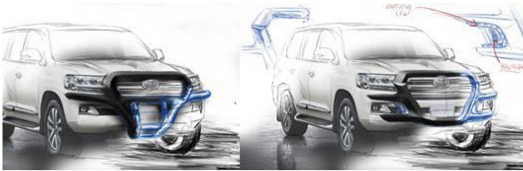
Şekil 3.11 Ön koruma sistemi için önerilen tasarım.
