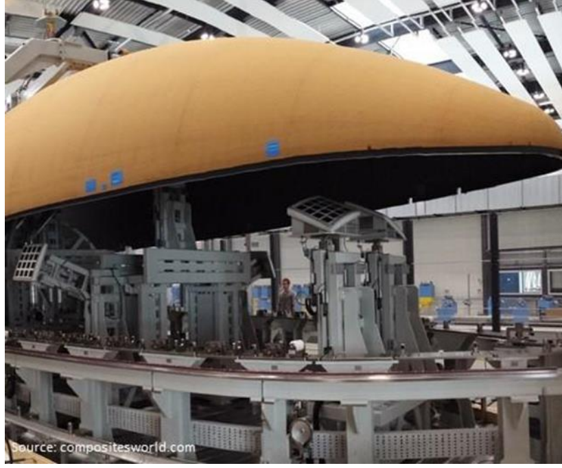
Şekil 5.5 Amorim P50 ablatif termal çözelti ile kaporta kabuğu [41].
