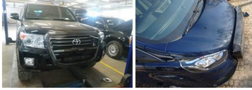
Şekil 3.17. Toyota Land Cruiser (solda) ve Ford Transit (sağda) üzerine monte edilmiş mantar ve CFRP'den yapılmış ön koruma sistemi.
