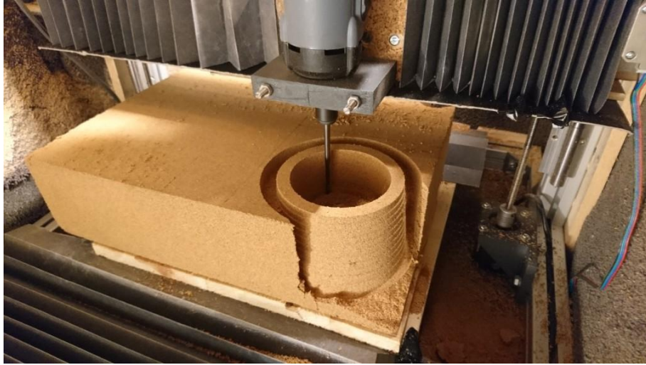
Şekil 4.5 Parmak freze çakısı ile mantar frezeleme [14].
