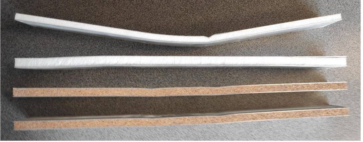
Şekil 3.8 Mantar ve sentetik çekirdek malzemeli sandviç paneller için hasar modu ve mekanizmalarının deney sonrası analizi.
