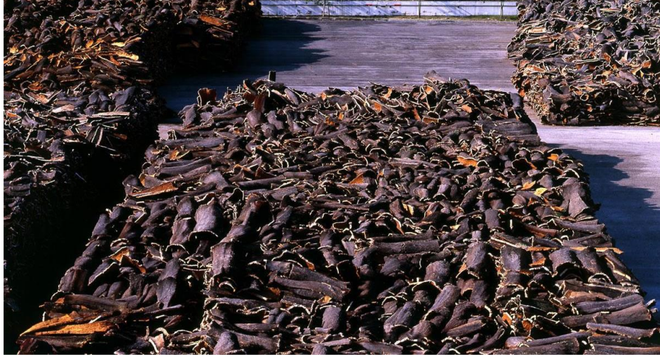
Şekil 1.19 Kamyondan boşaltıldıktan sonra avludaki kallaslar (APCOR'un izniyle © [1]).
