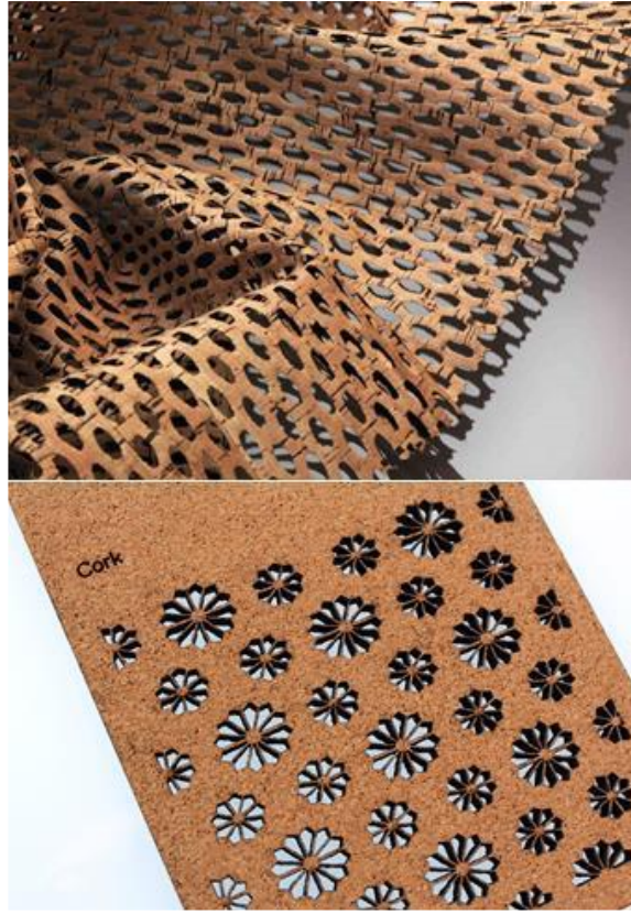
Şekil 4.4 Mantar bazlı kompozit paneller üzerinden lazer kesimi [11], [12].
