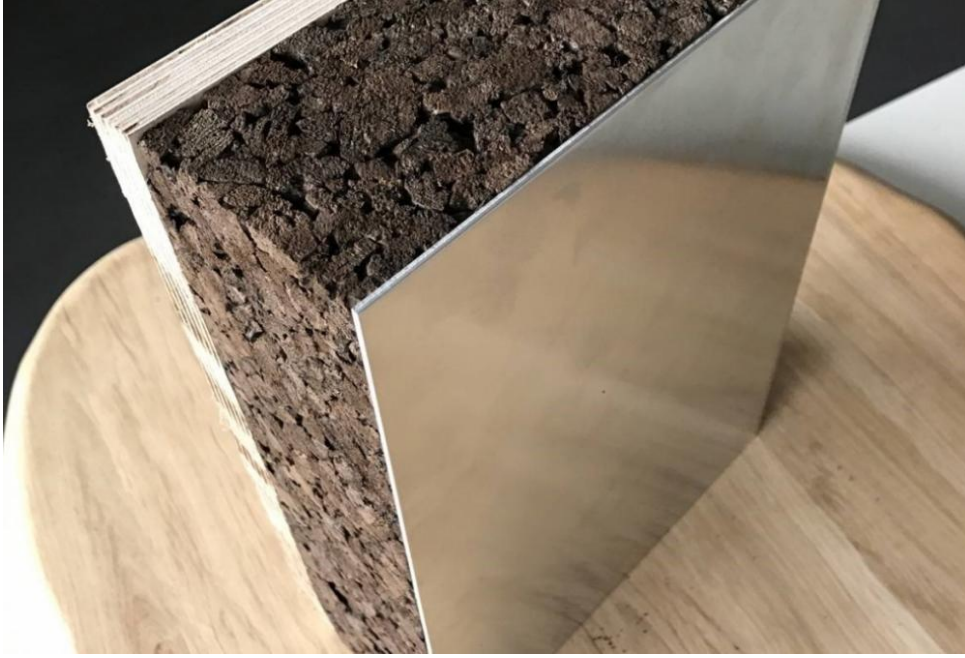
Şekil 4.10 Sandviç yapılı bir panel [23]. Bir tarafı kontrplak, diğer tarafı metal bir levha ile kaplanmıştır. İç dolgu granüle mantar malzemedен üretilmiştir.
