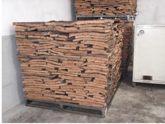
Şekil 1.30 Kaynatma sonrası mantar kalaslar.
