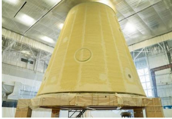
Şekil 5.13 Fırlatma Aracı Kademe Adaptörü üzerinde sprey köpük ısı yalıtımı [48].
