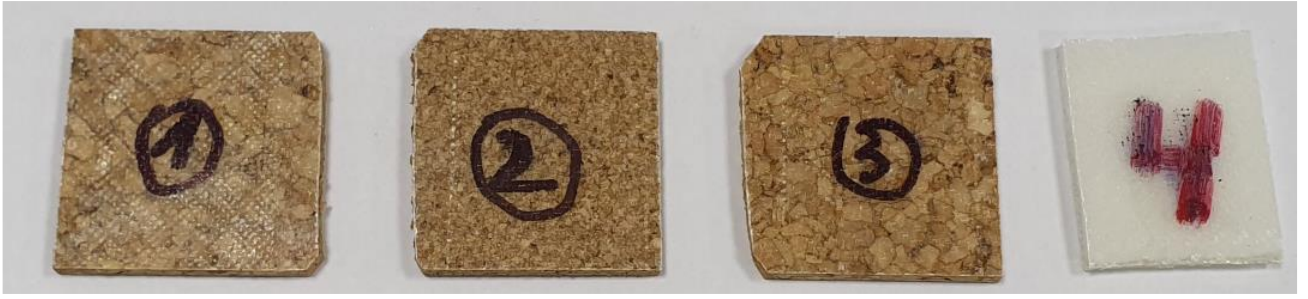
Şekil 4.28 Araştırma nesnelere (1-3 lamine mantar malzeme; 4 lamine polimetakrilimid köpük malzeme). Nesnelere boyutları 1-3 nesne için ~ 30x30x3 mm. ve 4 numaralı nesne için ~ 25x30x3 mm.
