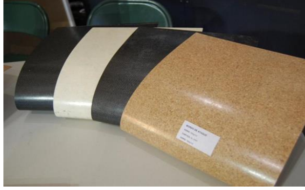
Şekil 5.10 AEROCORK mantar kompozit malzemesi [44].
