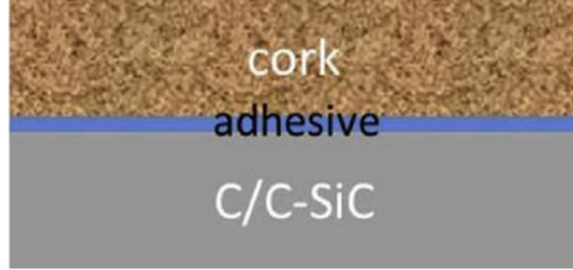
Şekil 5.12. Mantar ve seramik matrisli kompozitlerin şematik konfigürasyonu [47].
