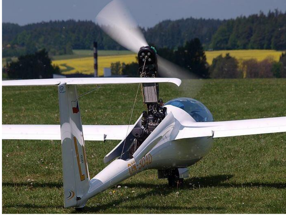
Şekil 4.7. Bir motorlu planör [20]. Gövdesinin üst kısmında açık bir motor bölmesi görülürken, gövdenin alt kısmında bir yürüyen aksam tekerlek yuvası gözlemlenebilir. Bu yapısal elemanlar mantar bazlı sandviç yapılı kompozitler kullanılarak üretilebilir.
