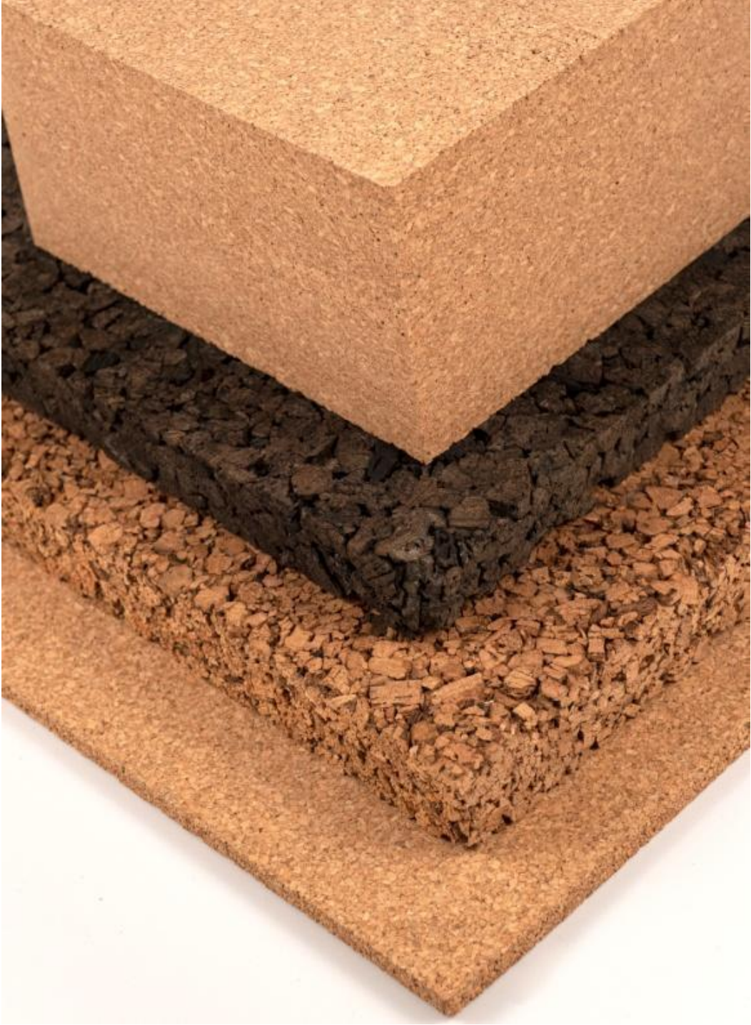
Şekil 2.16 Aglomere mantar levhalar. Üstten başlayan ikinci levha, ısıyla genişletilmiş mantar levhadır. Diğerleri mantar kompozit örnekleridir. Kaynak: ICSuro.
