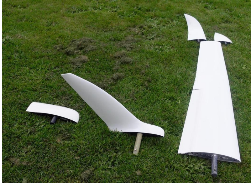
Şekil 4.6 Planör kanadının dört kanatçık tipine sahip kısmı [18].
