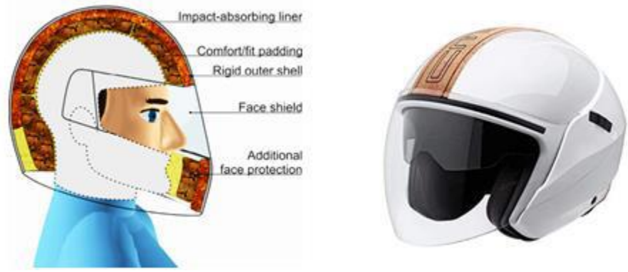
Şekil 3.19 Mantar tabanlı motosiklet kaskı konsepti (solda) ve mantar kabuk tasarımı bir kask (sağda) [69].
