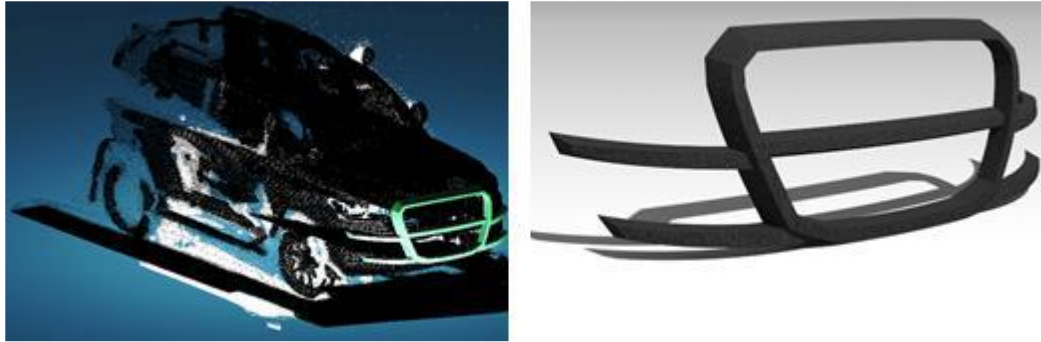
Şekil 3.13 Toyota Land Cruiser FPS modelleri (solda) ve FPS render (sağda) ile nokta bulutu.
