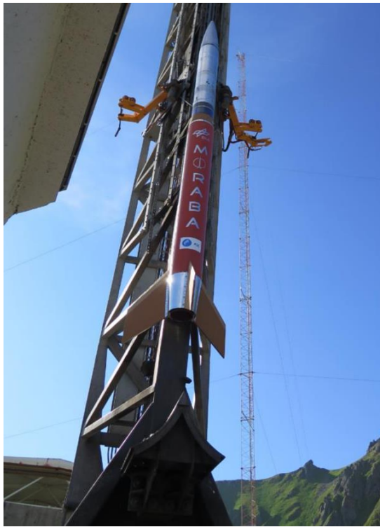
Figura 5.7 Veículo Malemute melhorado (IM) com TPS à base de cortiça na barbatana [43].
