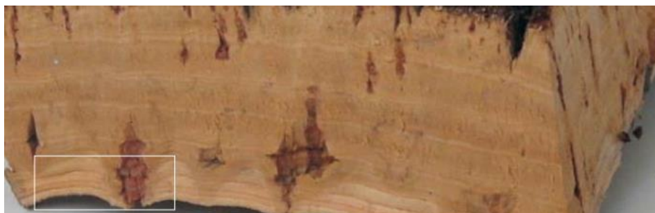
Figura 1 Exemplo do defeito de cortiça húmida [58].
