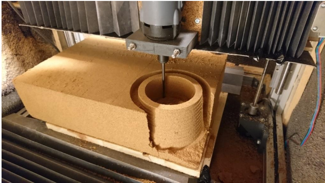
Figura 4.5 Fresagem de cortiça com uma fresa de topo [14].
