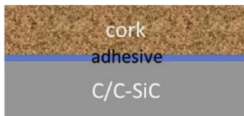
Figura 5.12 Configuração esquemática do compósito de cortiça e matriz cerâmica [47].
