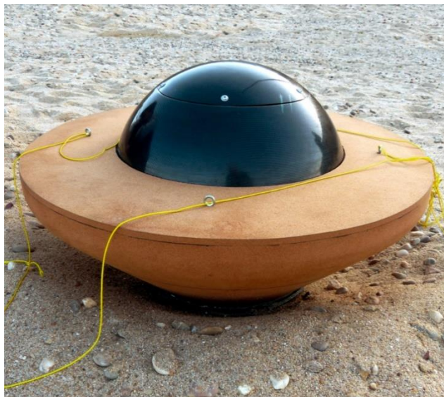
Figura 5.14 Cápsula de aterragem de Marte revestida por compósito de cortiça [49].
