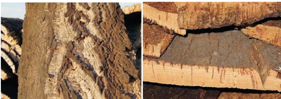
Figura 1.25 Pranchas com sulcos profundos [58].
