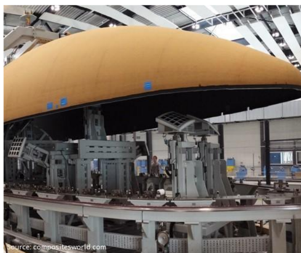
Figura 5.5 Carenagem com solução térmica ablativa Amorim P50 [41].
