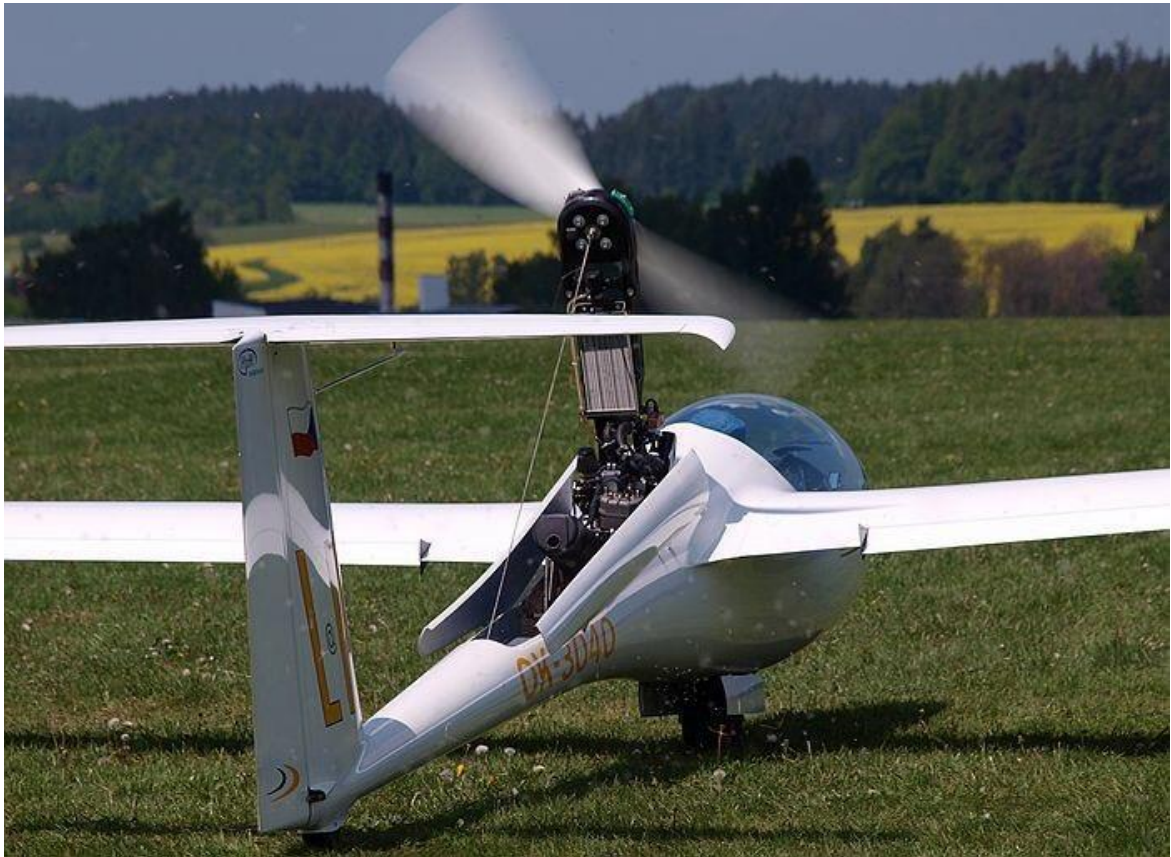
Figura 4.7: Um planador a motor [20]. Na parte superior da fuselagem pode ver-se um compartimento aberto para o motor, enquanto na parte inferior da fuselagem se pode observar um poço para as rodas do trem de aterragem. Estes elementos estruturais podem ser fabricados com compósitos sanduíche à base de cortiça.
