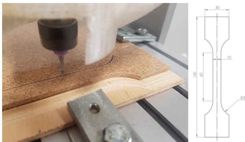
Figura 4.44 Fresagem e dimensões da amostra.
