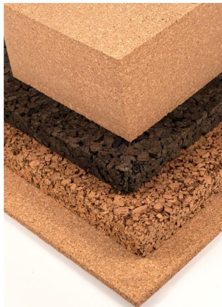
Figura 2.16 Placas de cortiça aglomerada. A segunda placa, começando de cima, é uma placa de cortiça termoexpandida. Os outros são exemplos de compósitos de cortiça.
