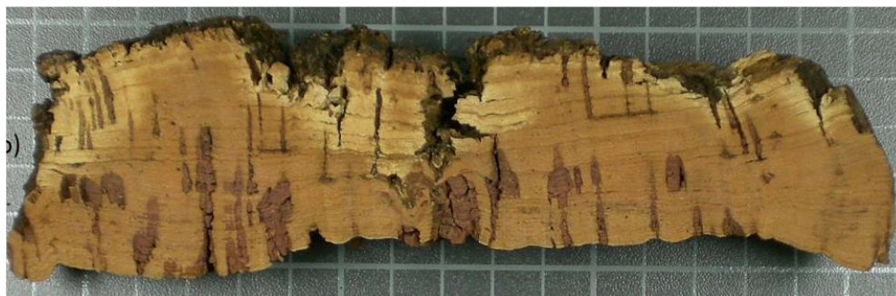
Figura 1.26 Exemplo de uma mancha amarelada em um pedaço de cortiça [59].
