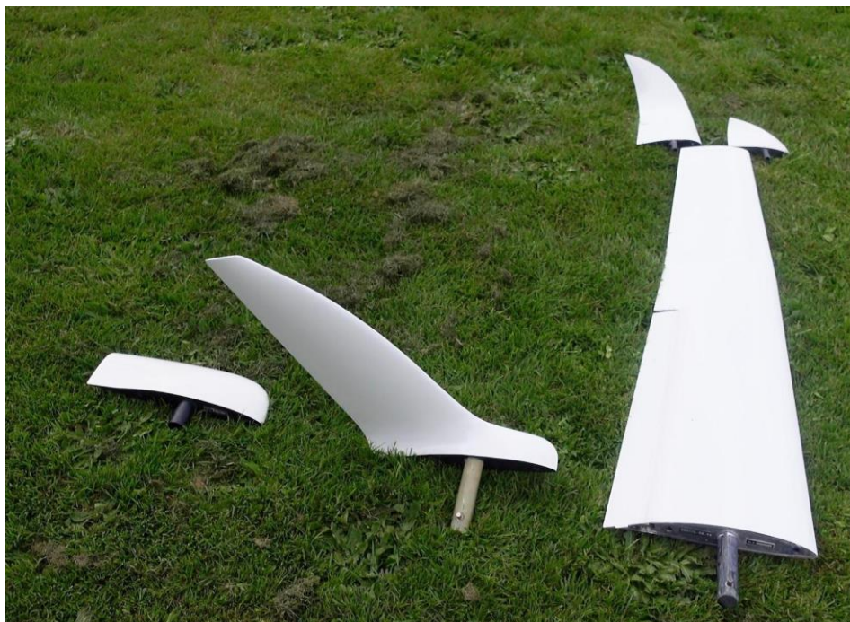
Figura 4.6 A parte da asa do planador com quatro tipos de winglets [18].
