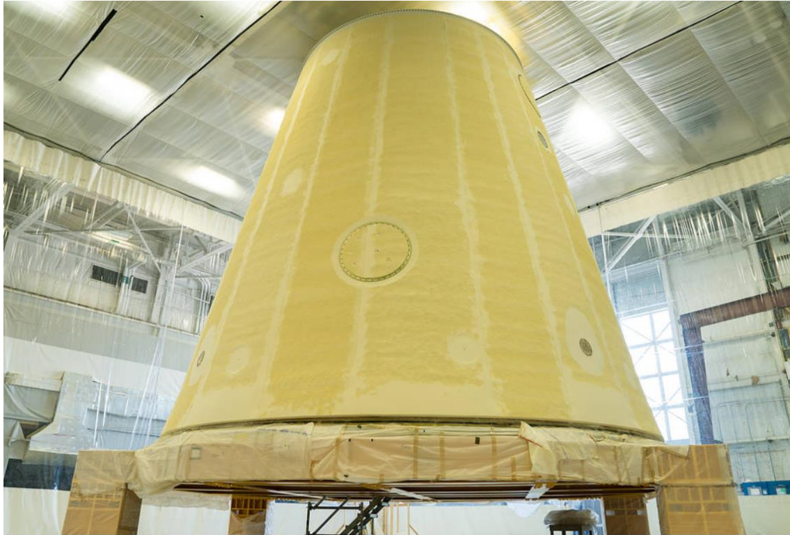
Figura 5.13 Isolamento térmico por pulverização de espuma no Adaptador de Estágio do Veículo de Lançamento (LVSA) [48].
