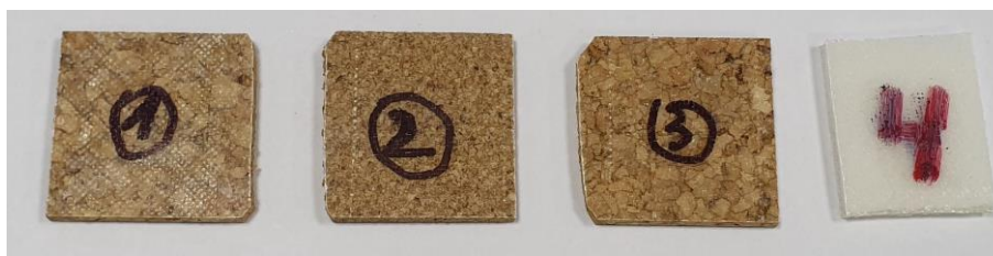
Figura 4.28 Amostras (1-3 compósito laminado de cortiça; 4 compósito laminado com espuma de polymethacrylimide). Dimensões para amostras 1-3: 30x30x3 mm; 4: 25x30x3mm.
