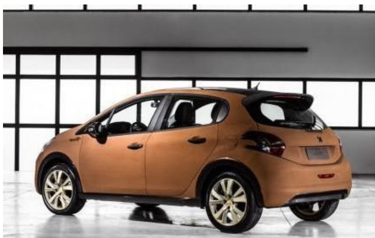
Figura 2.18 Peugeot 208 Natural com compósito de cortiça no tejadilho [81].
