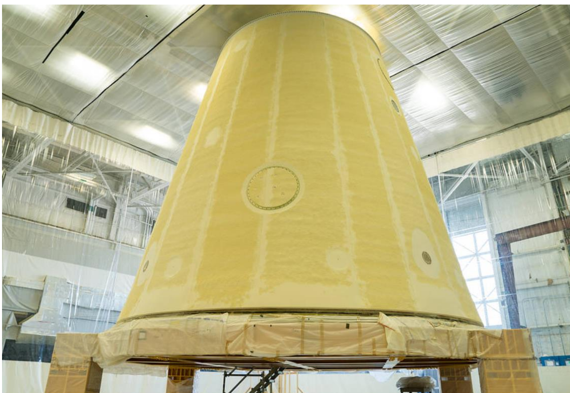
Rysunek 5.13 Natryskiwana piankowa izolacja termiczna adaptera stopnia pojazdu startowego [48].
