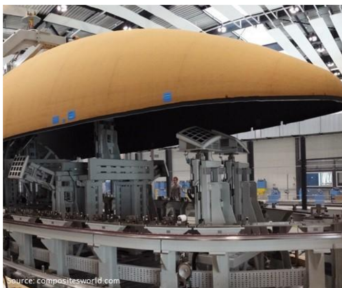
Rysunek 5.5 Powłoka owiewki z ablacyjnym rozwiązaniem termicznym Amorim P50 [41].
