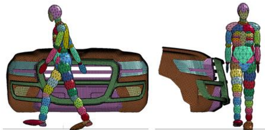
Rysunek 3.15 Dyskretny model przodu pojazdu z zamontowanym FPS i manekinem MADYMO 50 percentyla.
