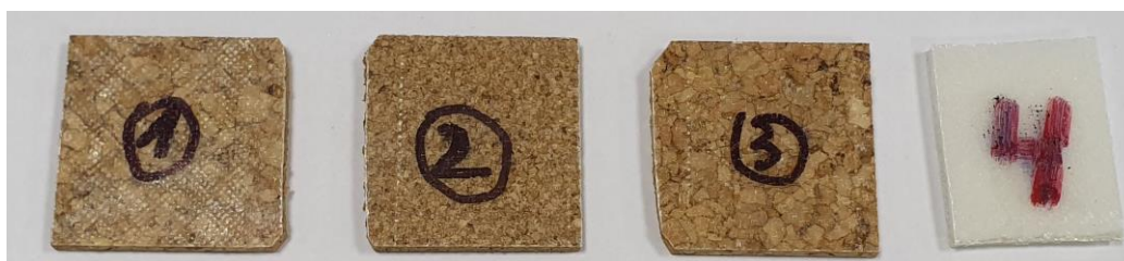
Rysunek 4.28 Obiekty badań (1-3: laminowany materiał korkowy; 4: laminowane materiały piankowe polimetakryloimidowe). Wymiar obiektu 30x30x3 mm dla 1-3 obiektów i ~25x30x3mm dla obiektu 4.
