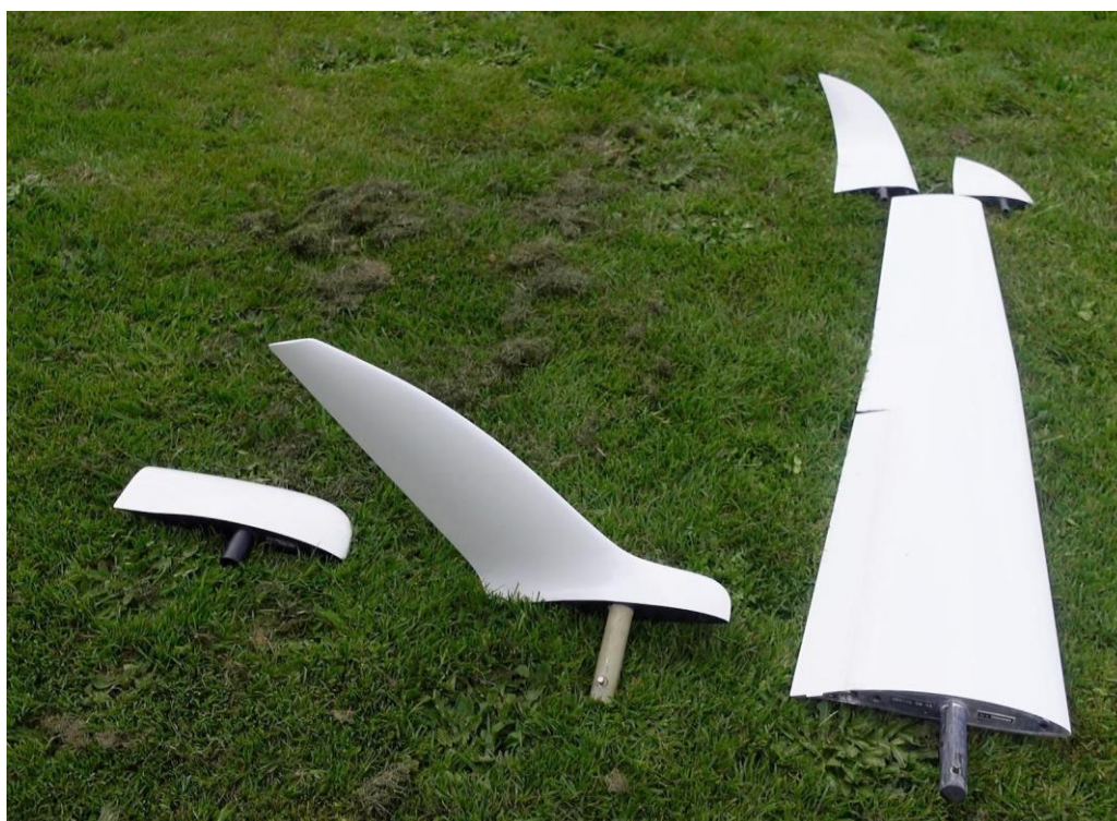
Rysunek 4.6 Część skrzydła szybowca z czterema typami wingletów [18].
