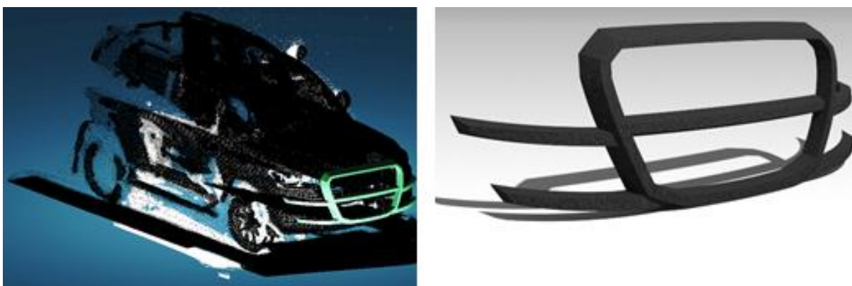
Rysunek 3.13 Chmura punktów Toyota Land Cruiser z modelami FPS (po lewej) i renderowaniem FPS (po prawej).
