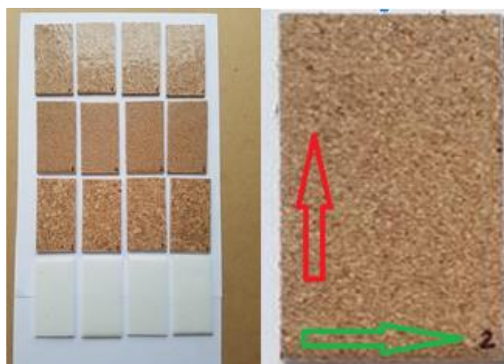
Rysunek 4.40 Panele przygotowane do próby zginania. Czerwona strzałka wskazuje 0 °, zielona 90 °.
