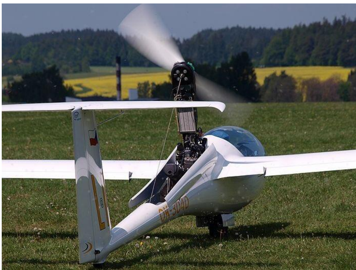
Rysunek 4.7. Motoszybowiec [20]. U góry widać otwartą komorę silnika kadłuba, natomiast w dolnej części kadłuba można było zaobserwować wnękę na koło podwozia. Te elementy konstrukcyjne można wytwarzać z kompozytów o strukturze warstwowej na bazie korka.
