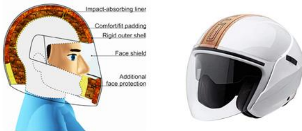
Rysunek 3.19 Koncepcja kasku motocyklowego z korka (po lewej) i kasku z korkową skorupą (po prawej) [69].
