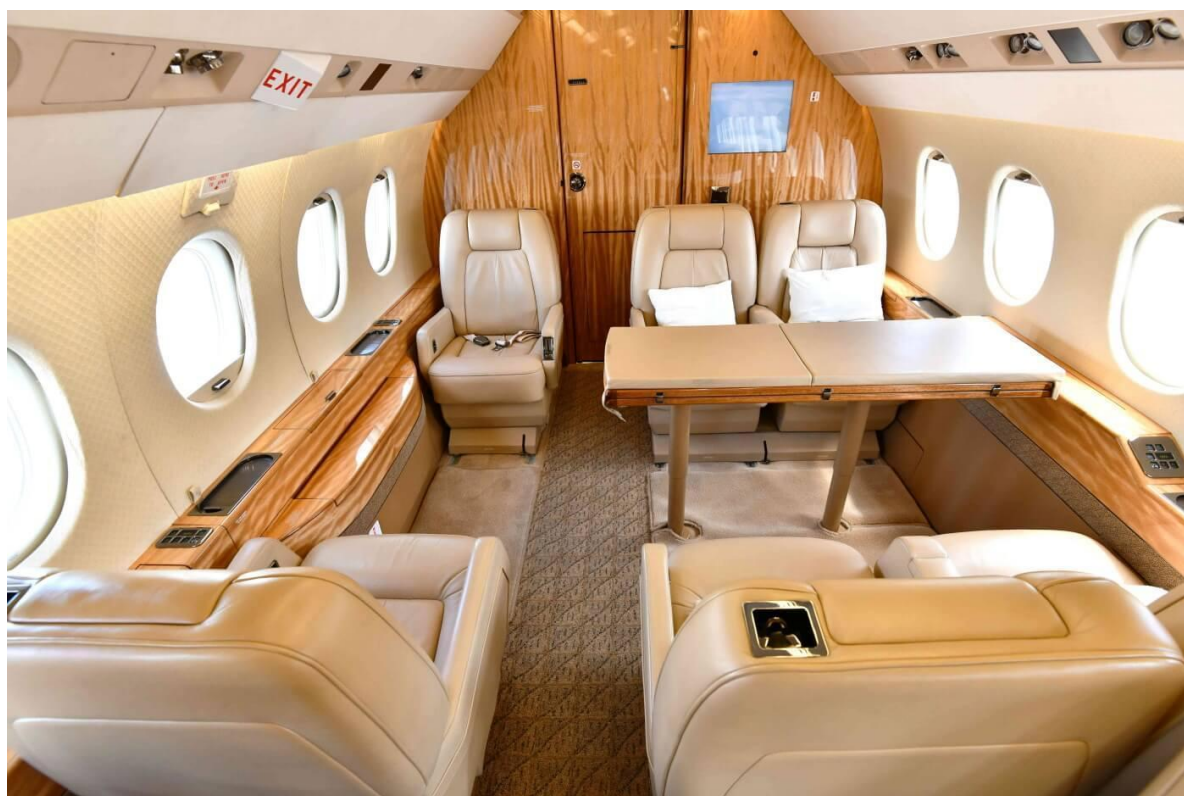
Rysunek 4.8 Kadłub samolotu klasy biznes [21]. Widoczna przegroda ozdobiona drewnem w tylnej części samolotu. Po prawej stronie między krzesłami zainstalowany jest składany stół.
