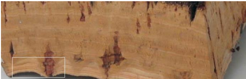
Rysunek 1.27 Przykład deski dotkniętej mokrym korkiem (zdjęcie z [58]).
