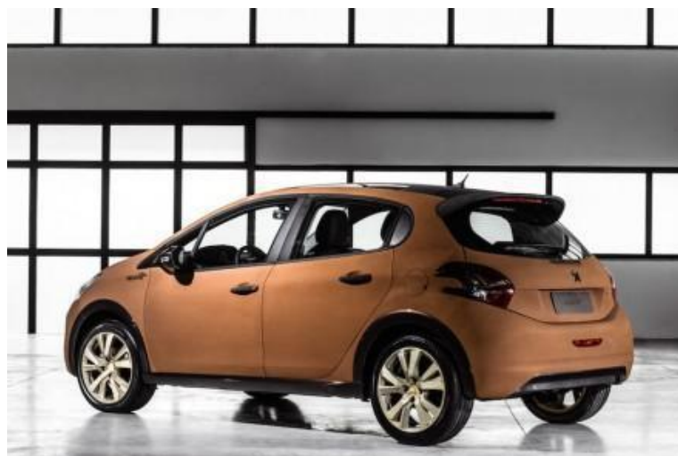
Rysunek 2.18 Peugeot 208 Natural z kompozytem korkowym w dachu [81].
