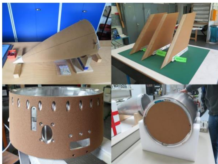
Rysunek 5.9 Implementacja NORCOAT LIEGE do różnych części konstrukcji raketowych [43].
