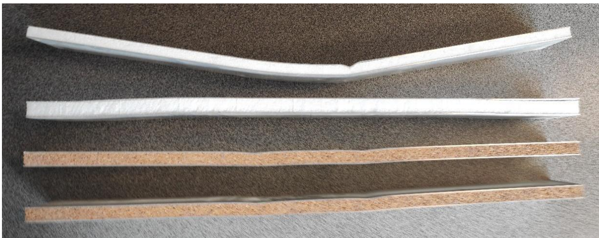
Rysunek 3.8 Analiza posteksperymentalna trybu i mechanizmów uszkodzeń płyt warstwowych z rdzeniem z korka i materiałów syntetycznych.
