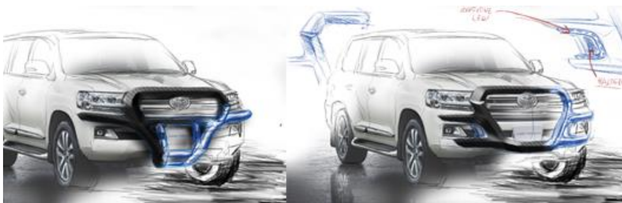
Rysunek 3.11 Proponowana konstrukcja przedniego układu zabezpieczającego.
