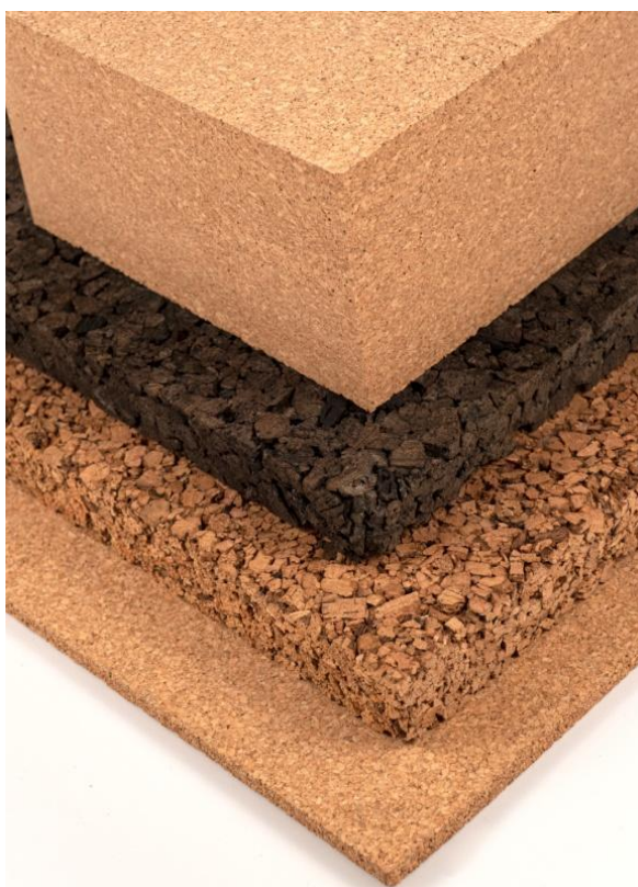
Rysunek 2.16 Aglomerowane płyty korkowe. Druga tablica zaczynając od góry to płyta korkowa termospieniona. Pozostałe to przykłady kompozytów korkowych.
