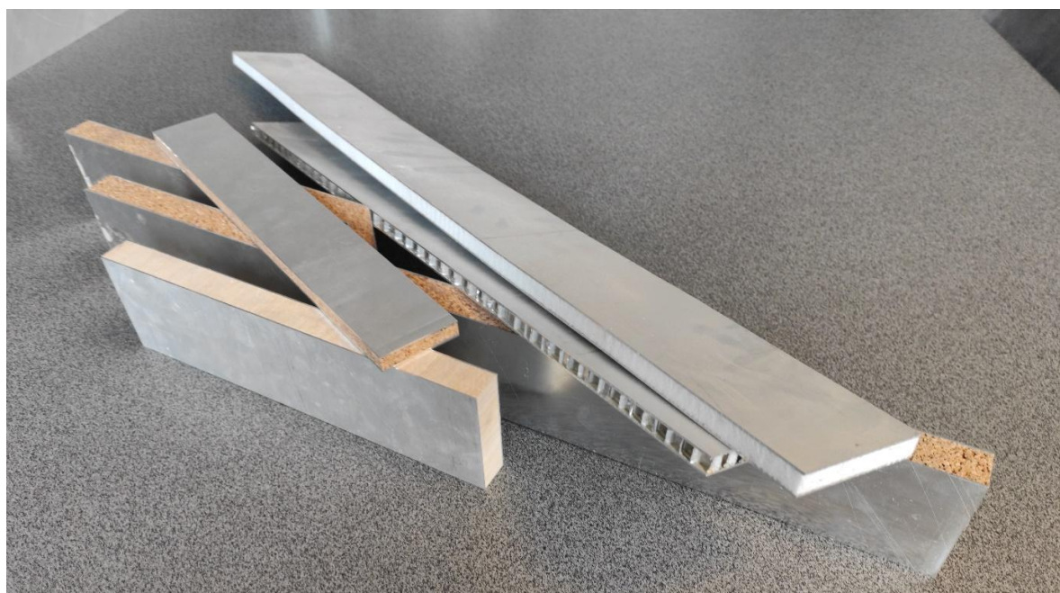
Rysunek 3.5 Panele warstwowe z drewnem balsy, korkiem, aluminiowym plastrem miodu i rdzeniem z pianki syntetycznej.
