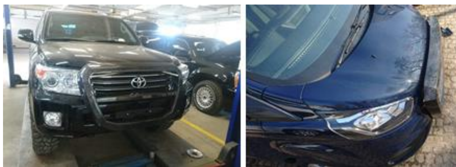
Rysunek 3.17 Przedni układ zabezpieczający wykonany z korka i CFRP montowany w Toyocie Land Cruiser (po lewej) i Fordzie Transit (po prawej).
