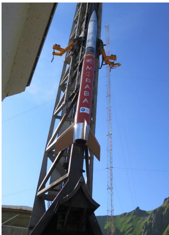
Rysunek 5.7 Udoskonalony pojazd Malemute (IM) z korkowym TPS na płetwie [43].
