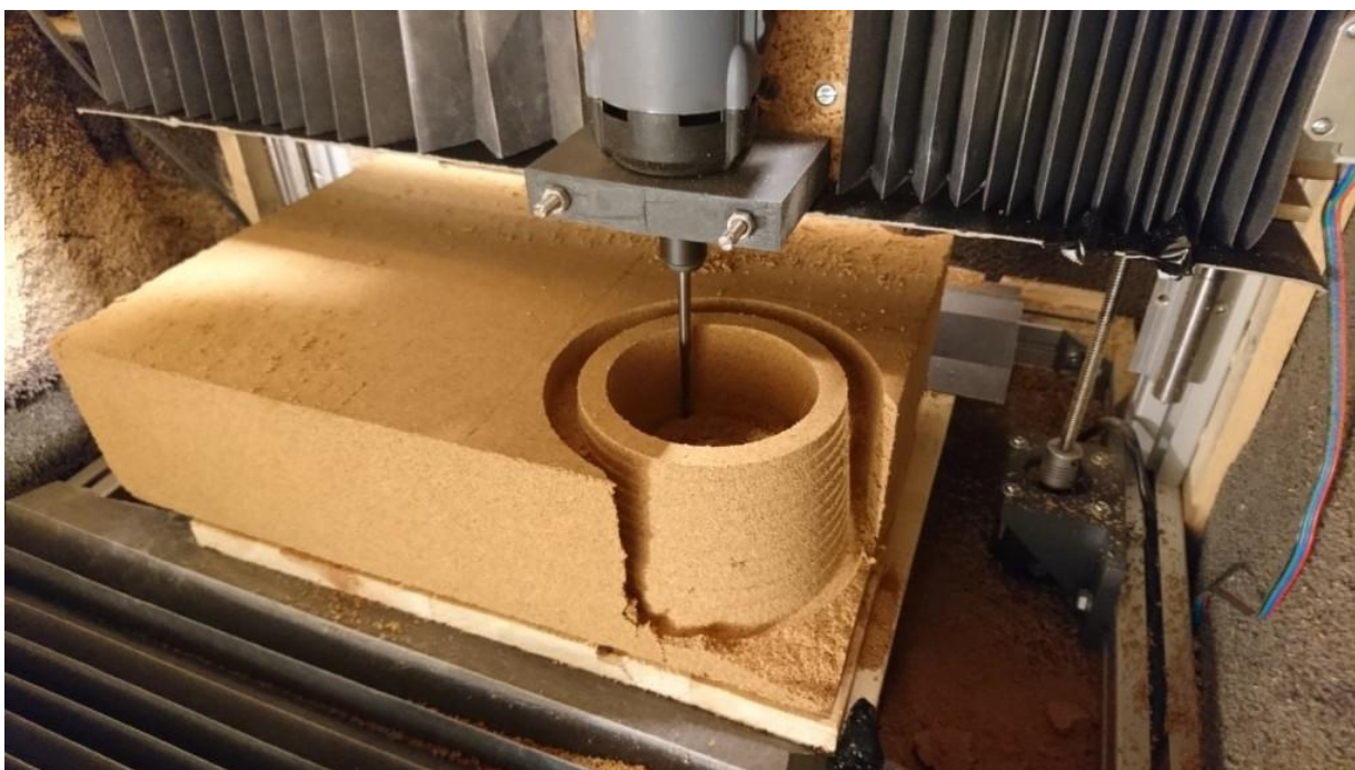
Rysunek 4.5 Frezowanie korka frezem palcowym [14].
