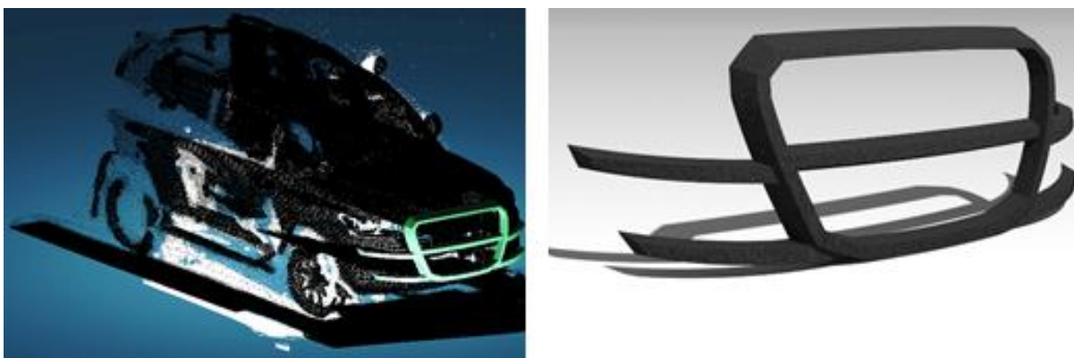
3.13 Pav. „Toyota Land Cruiser“ taškų debesis su FPS (kairėje) ir FPS atvaizdavimu (dešinėje).
