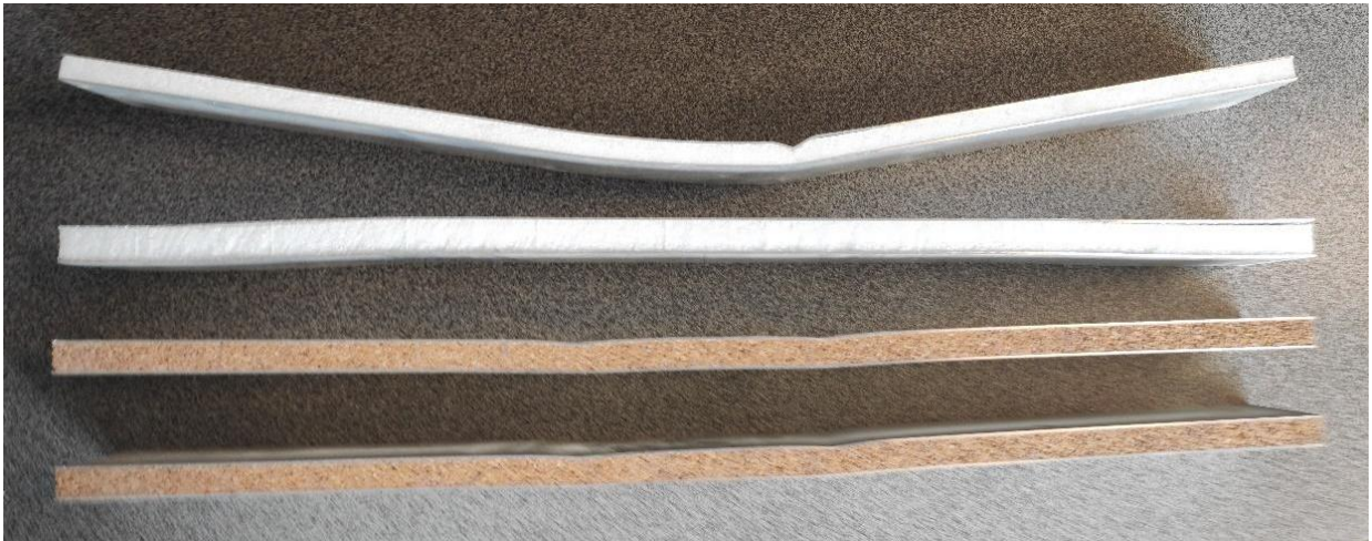
3.8 Pav. Trisluoksnių konstrukcijų su kamštiniu ir sintetiniu užpildu mechanizmo analizė po eksperimento
