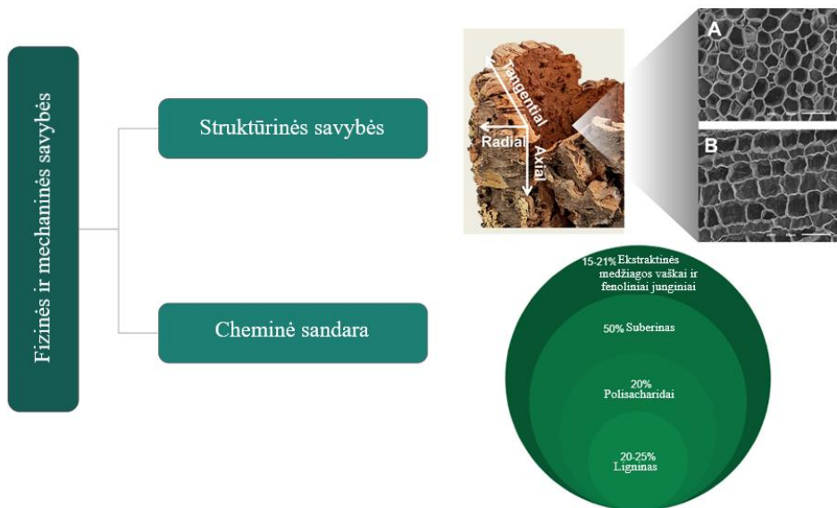
2.13 Pav. Kamštienos fizikinių ir mechaninių savybių schema: struktūrinės savybės ir cheminė sudėtis. SEM 3 mikrografijos, gautos iš mažo kamštienos gabalėlio, parodančios (a) tangentinį pjūvį ir (b) radialinį pjūvį [50].
