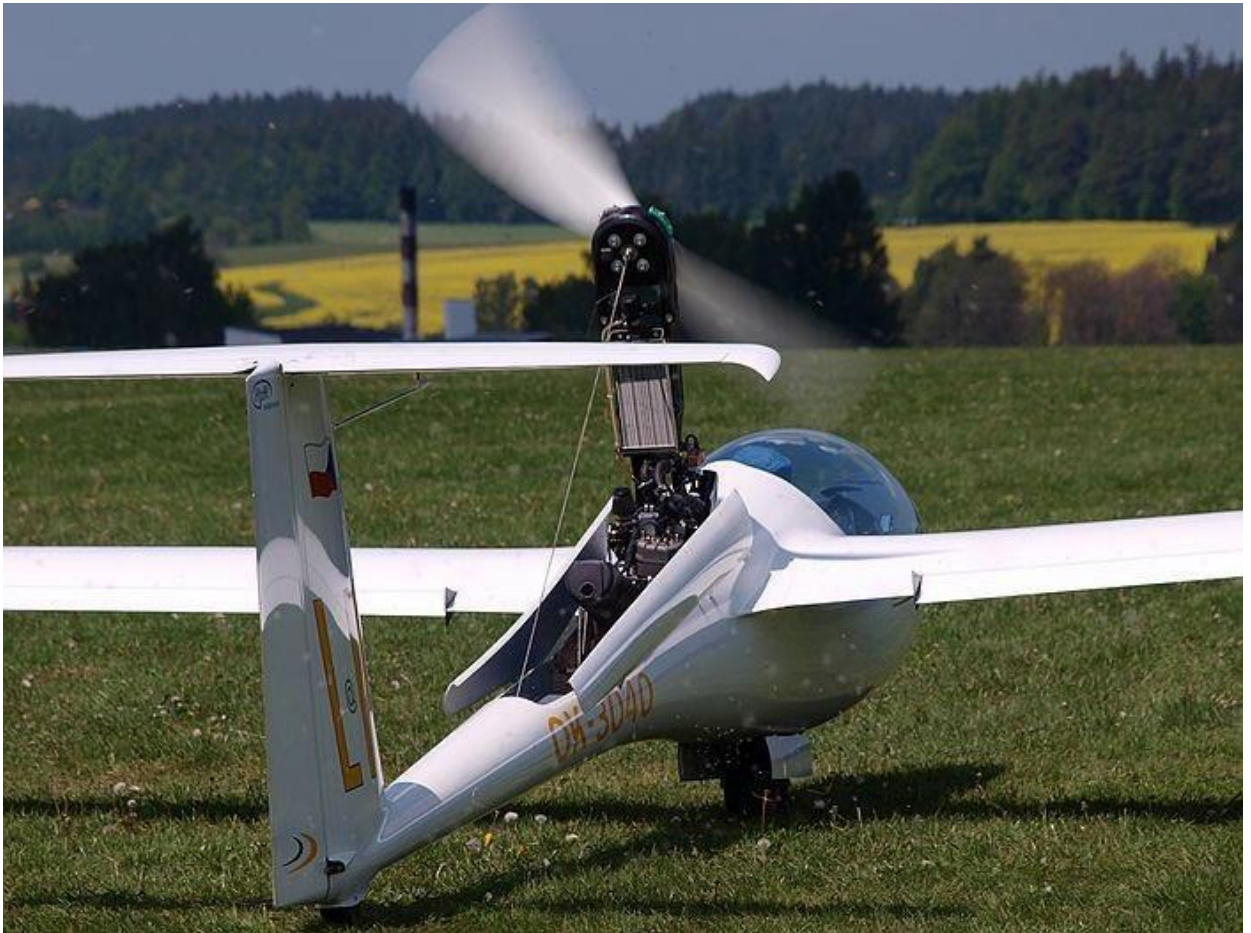
4.7. Pav. Motorizuotas sklandytuvas [20]. Jo liemens viršuje matyti atviros variklio skyriaus durelės, liemens apačioje – važiuoklės durelės. Šiuos konstrukcinius elementus galima gaminti naudojant trisluoksnes konstrukcijas su kamštiniu užpildu.
