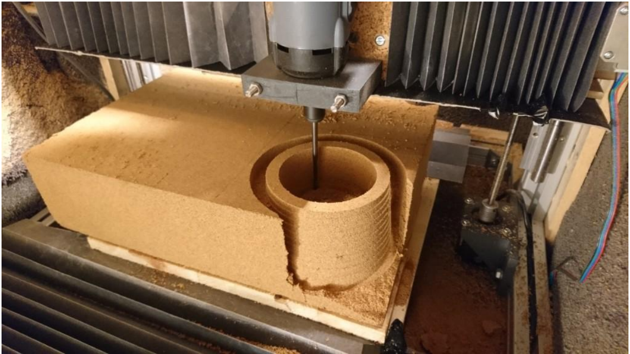
4.5. Pav. Kamštienos frezavimas pirštine freza [14].
