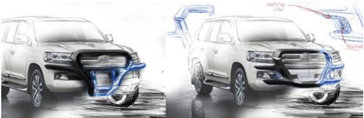
3.11 Pav. Siūloma priekinės apsaugos sistemos konstrukcija
