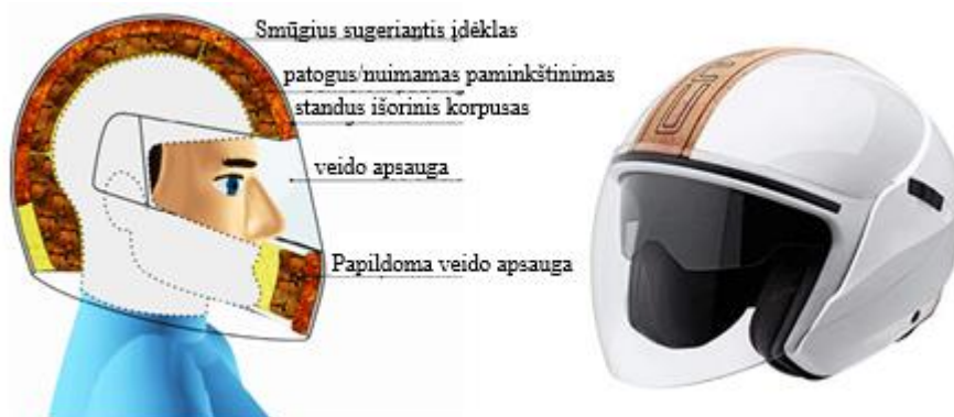
3.19 Pav. Kamštiesenos pagrindu pagaminto motociklininko šalmo koncepcija (kairėje) ir šalmas su kamštiesenos korpuso konstrukcija (dešinėje) [69]
