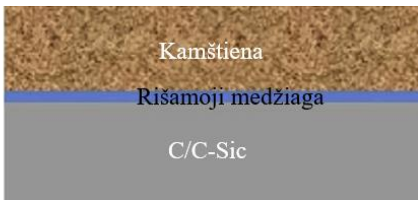
5.12 Pav. Kamštienos ir keraminės matricos kompozicinių medžiagų konfiguracijos schema [47]
