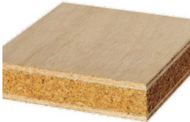
4.9. Pav. Trisluoksni sumuštinio tipo plokštė, kurios vidus užpildytas kamštine medžiaga o iš abiejų pusių išorėje priklijuoti medienos sluoksniai [22].
