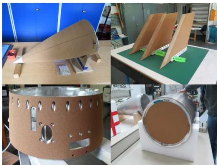
5.9 Pav. NORCOAT LIEGE taikymas įvairioms raketų konstrukcijų dalims [43]
