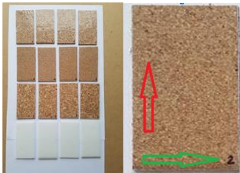
4.40. Pav. Paruoštos plokštelės lenkimo bandymui. Raudona rodyklė rodo 0°, žalia 90°.
