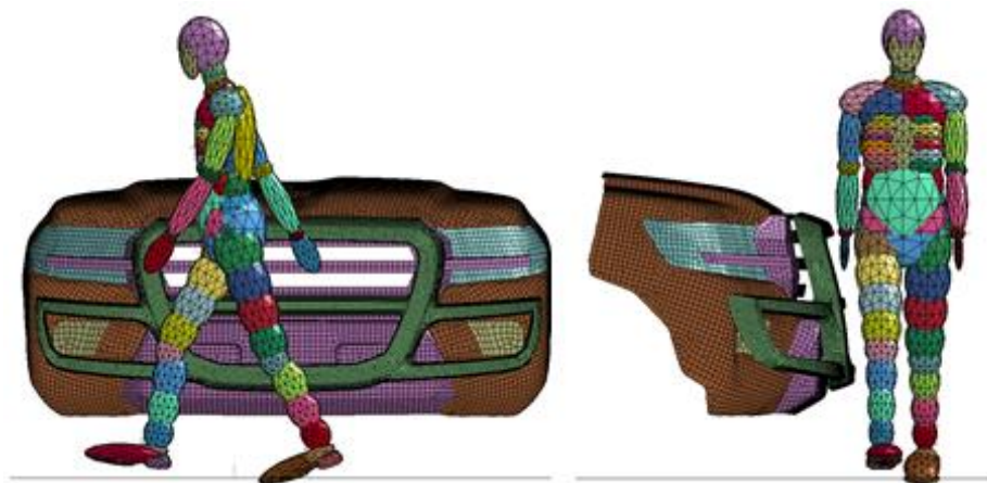
3.15 Pav. Transporto priemonės priekinės dalies diskretusis modelis su sumontuota priekinės apsaugos sistema (FPS) ir MADYMO 50-ies procentilių vyro manekeno modelis
