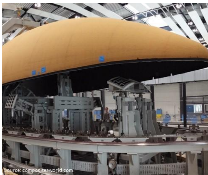
5.5 Pav. Apsauginis korpusas su „Amorim P50“ abliaciniu šiluminiu tirpalu [41]
