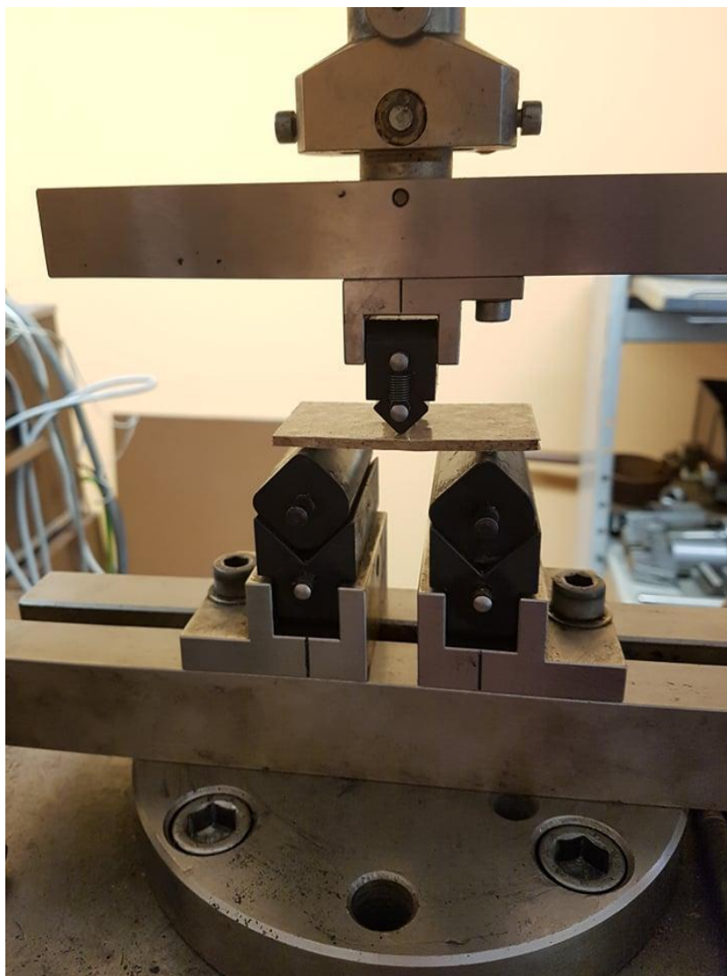
4.41. Pav. Lenkimo bandymo stendas
