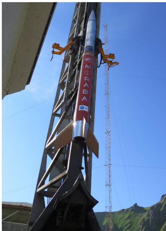
5.7 Pav. Patobulinta Malemute (IM) transporto priemonė, aprūpinta patobulinta kamštine šiluminės apsaugos sistema, sumontuota ant jos peleko [43]
