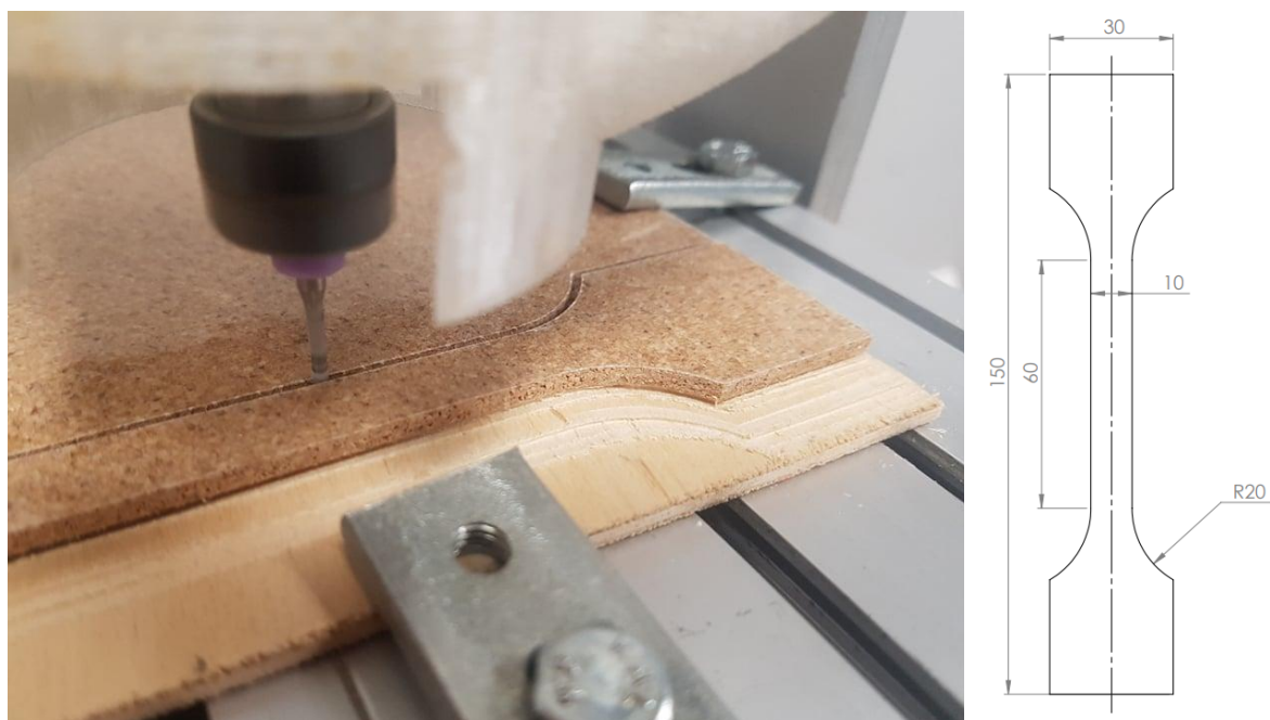
4.44. Pav. Bandinių frezavimas ir matmenys.
