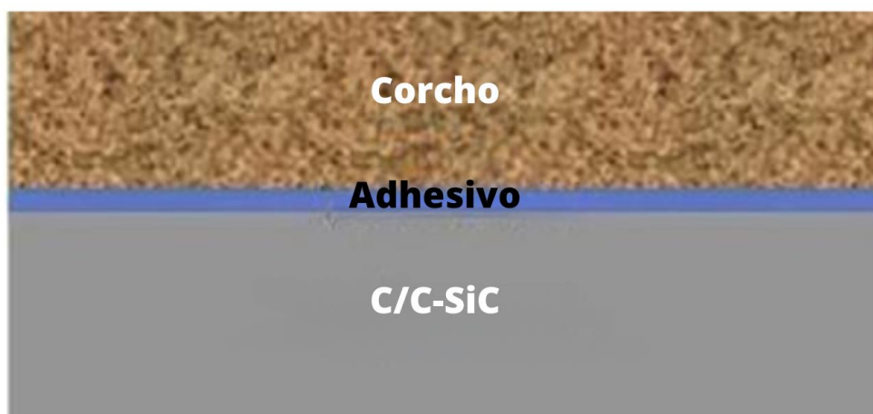
Figura 5.12. Una configuración esquemática de compuestos de corcho y matriz cerámica [47].
