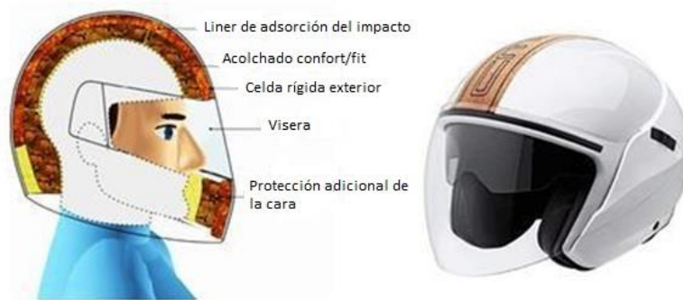
Figura 3.19 Concepto de casco de motocicleta basado en corcho (izquierda) y casco con diseño de carcasa de corcho (derecha) [69].
