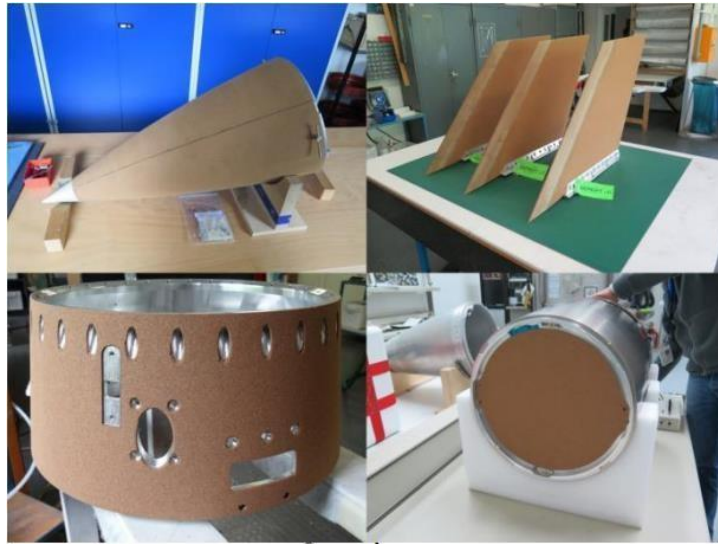
Figura 5.9 Implementación de NORCOAT LIEGE en varias partes de estructuras de cohetes [43].
