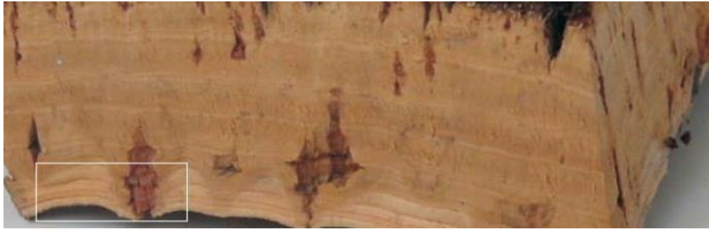
Figura 1.27 Ejemplo de plancha afectado por corcho verde (imagen de [58]). Clasificación de calidad de las planchas de corcho
