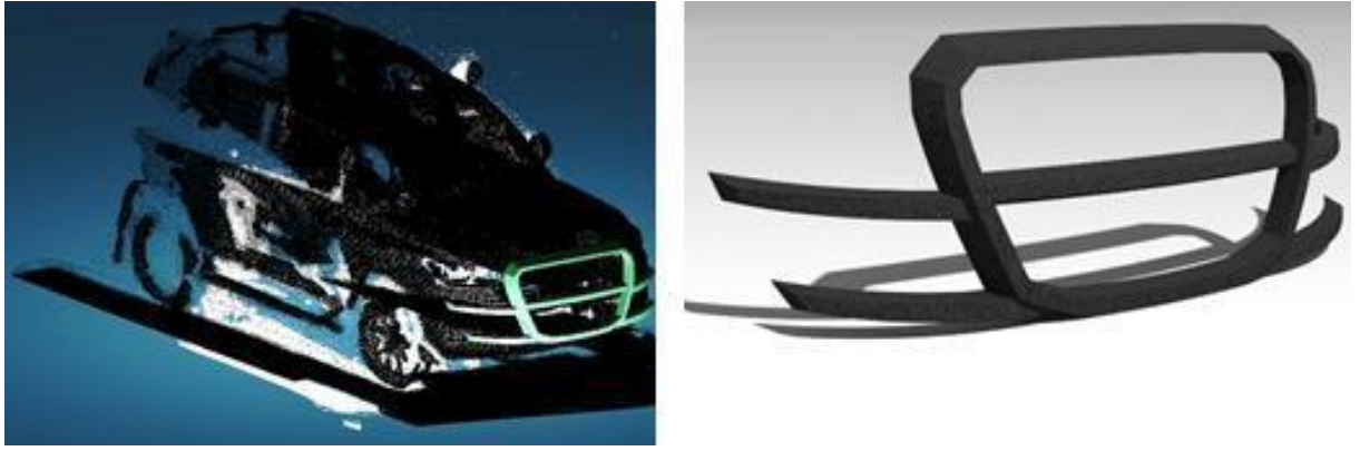
Figura 3.13 Nube de puntos de Toyota Land Cruiser con modelos FPS (izquierda) y representación FPS (derecha).
