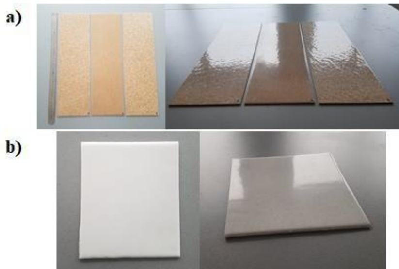
Figura 4.39 a) Paneles estructurados en sándwich con diferentes rellenos compuestos a base de corcho, b) Paneles estructurados en sándwich con relleno de espuma de polimetacrilimida.
