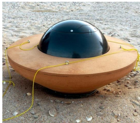
Figura 5.14 Cápsula de aterrizaje en Marte recubierta de compuesto de corcho [49].
