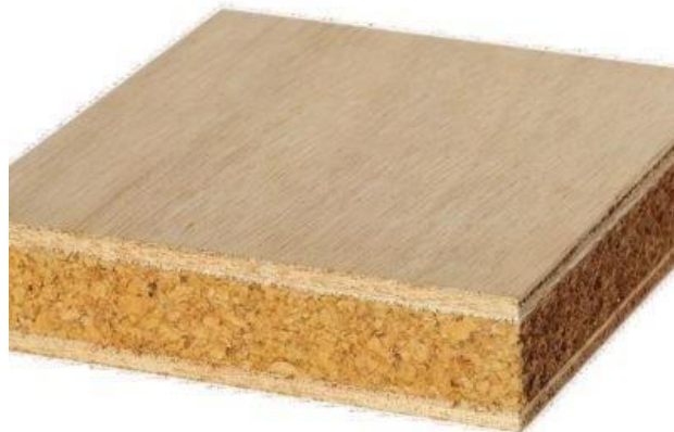
Figura 4.9 . Panel con estructura tipo sándwich relleno con aglomerado de corcho y láminas de madera adheridas a ambos lados externos [22].
