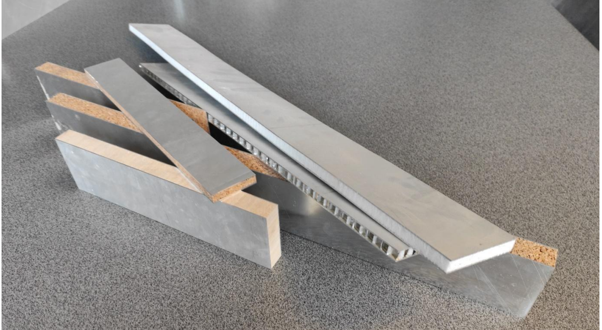
Figura 3.5 Paneles sándwich con núcleo de madera, corcho, nido de abeja de aluminio y espuma sintética.
