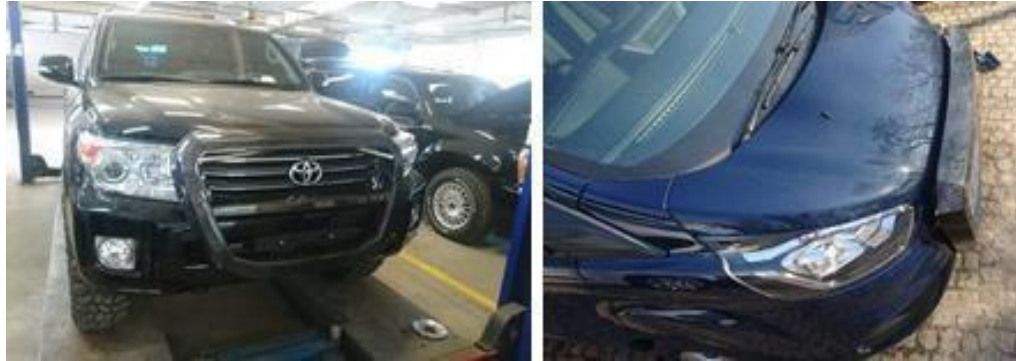
Figura 3.17 Sistema de protección frontal de corcho y CFRP montado en Toyota Land Cruiser (izquierda) y Ford Transit (derecha).
