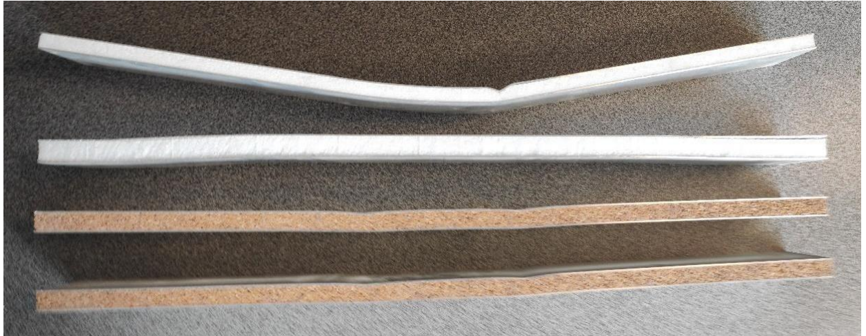
Figura 3.8 Análisis posterior al experimento del modo de daño y los mecanismos para paneles sándwich de corcho y materiales de núcleo sintético.
