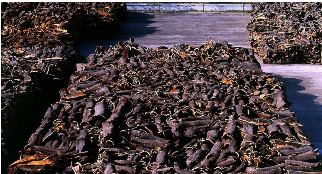
Figura 1.19 Planchas de corcho en el patio de una empresa de preparación de corcho después de descargarlos del camión (fuente APCOR © [1]).
