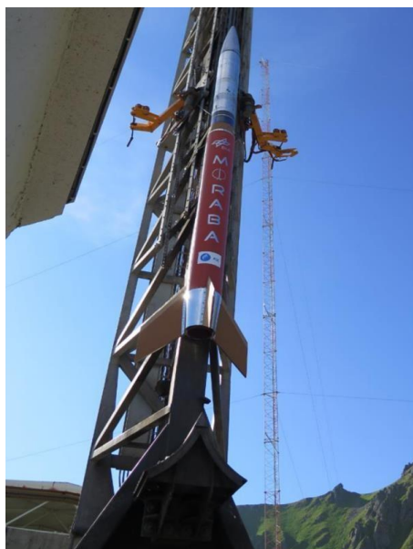
Figura 5.7 Vehículo Malemute mejorado (IM) con TPS basado en corcho en la aleta [43].
