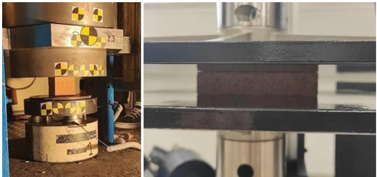
Figura 3.1 Muestras de corcho en el ensayo de compresión.
