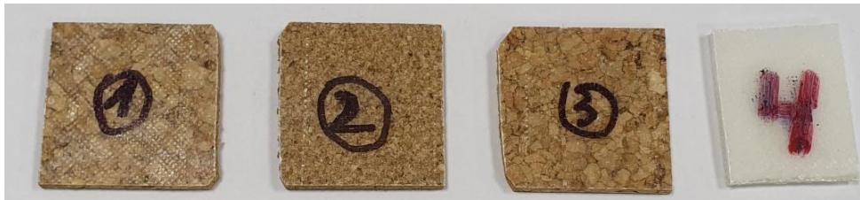
Figura 4.28 Objetos de investigación (1-3: material laminado de corcho; 4: materiales laminados de espuma de polimetacrilimida). La dimensión del objeto 30x30x3 mm para 1-3 objetos y ~ 25x30x3mm para el objeto 4.
