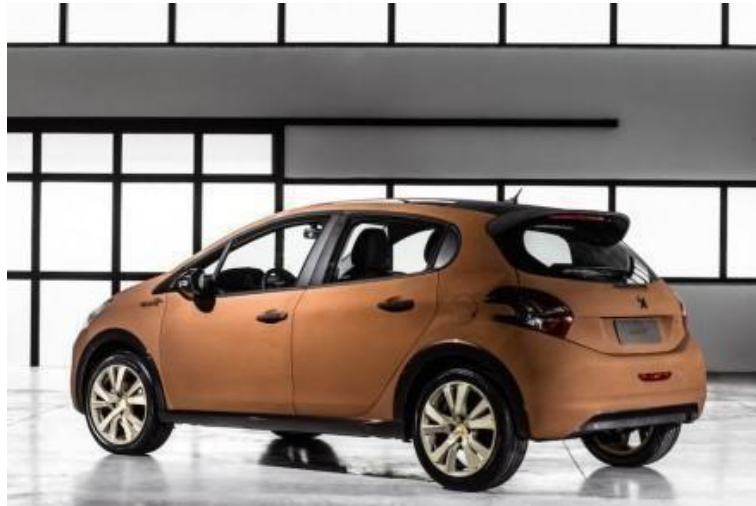
Figura 2.18 Peugeot 208 Natural con composite de corcho en el techo [81].
