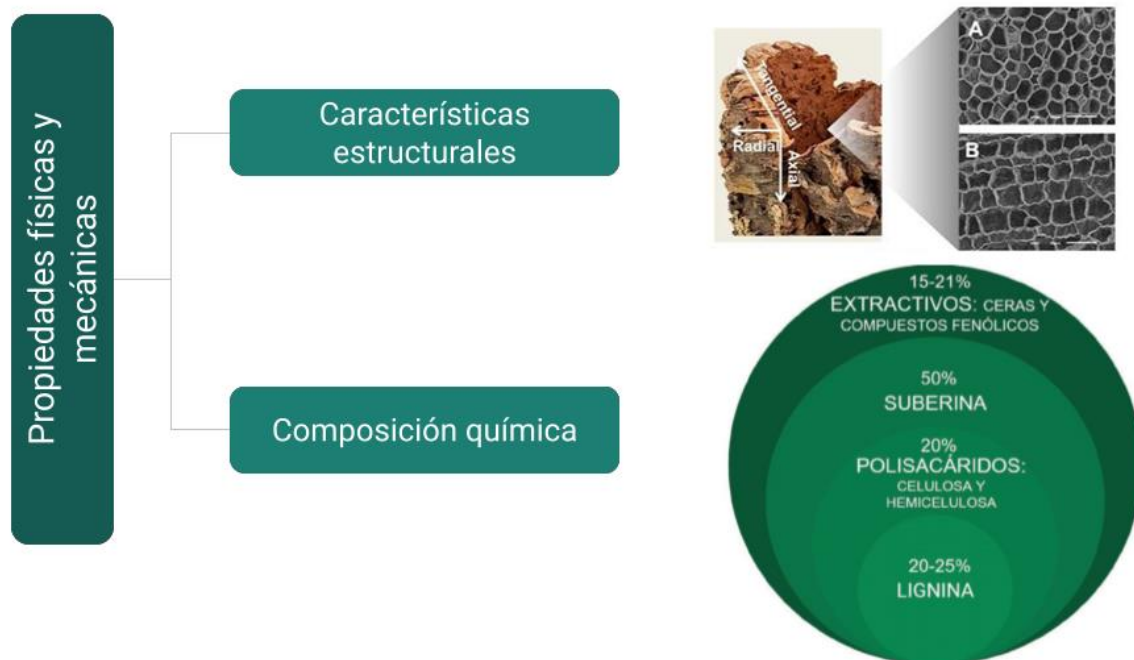
Figura 2.13 Representación esquemática de las propiedades físicas y mecánicas del corcho: características estructurales y composición química. Micrografías SEM tomadas de un pequeño cubo de corcho (a) sección tangencial y (b) sección radial [50].
