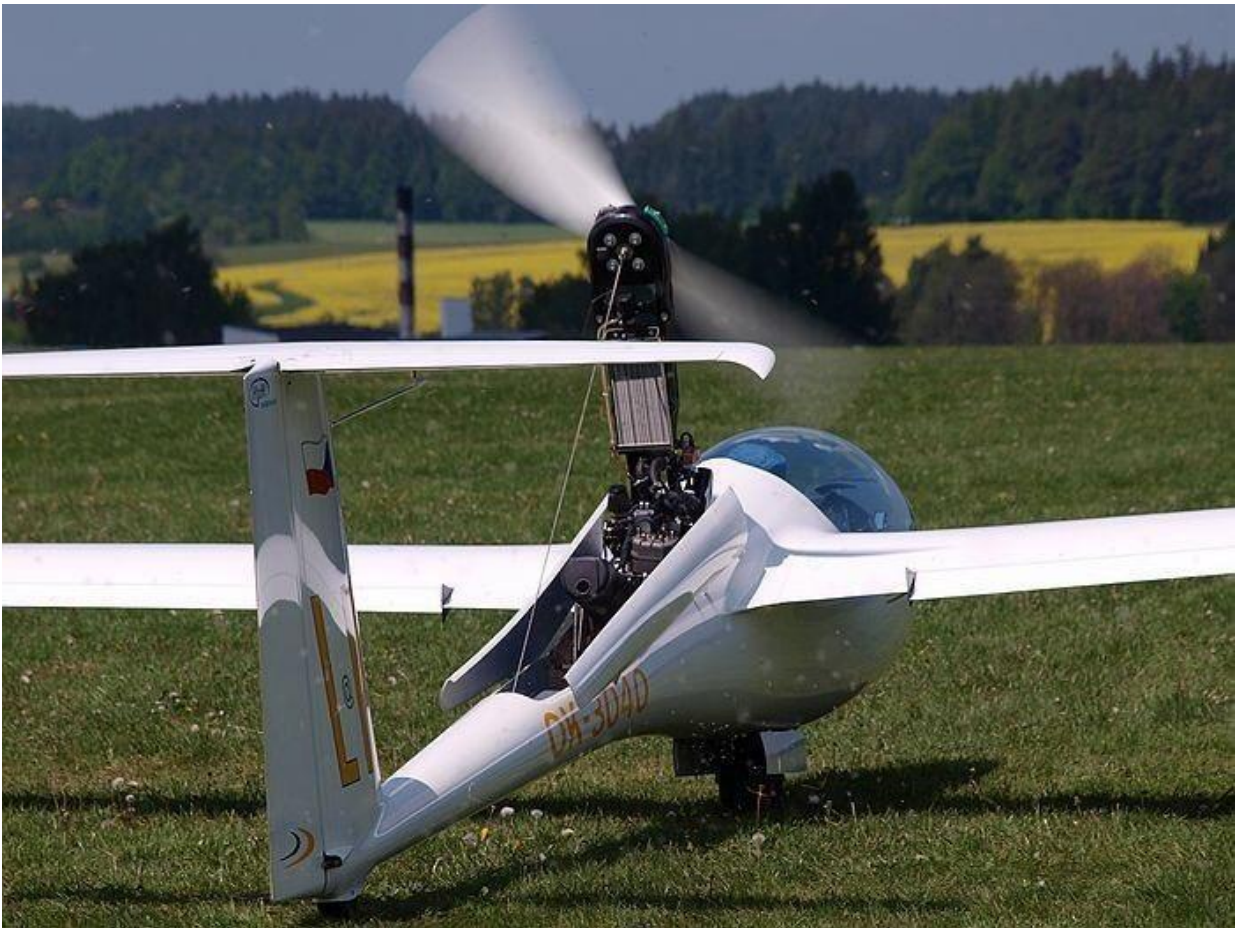
Figura 4.7 . Un planeador motorizado [20]. Se puede ver un compartimento de motor abierto en la parte superior de su fuselaje, mientras que se puede observar un espacio para las ruedas del tren de aterrizaje en la parte inferior del fuselaje. Estos elementos estructurales podrían fabricarse utilizando materiales compuestos estructurados en sándwich a base de corcho.
