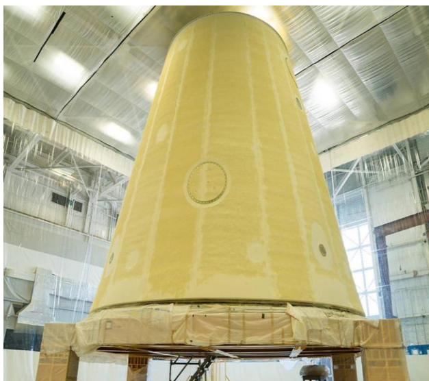
Figura 5.13 Aislamiento térmico de espuma en aerosol en el adaptador de escenario del vehículo de lanzamiento [48].
