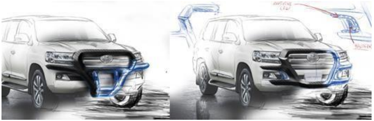
Figura 3.11 El diseño propuesto del sistema de protección frontal.
