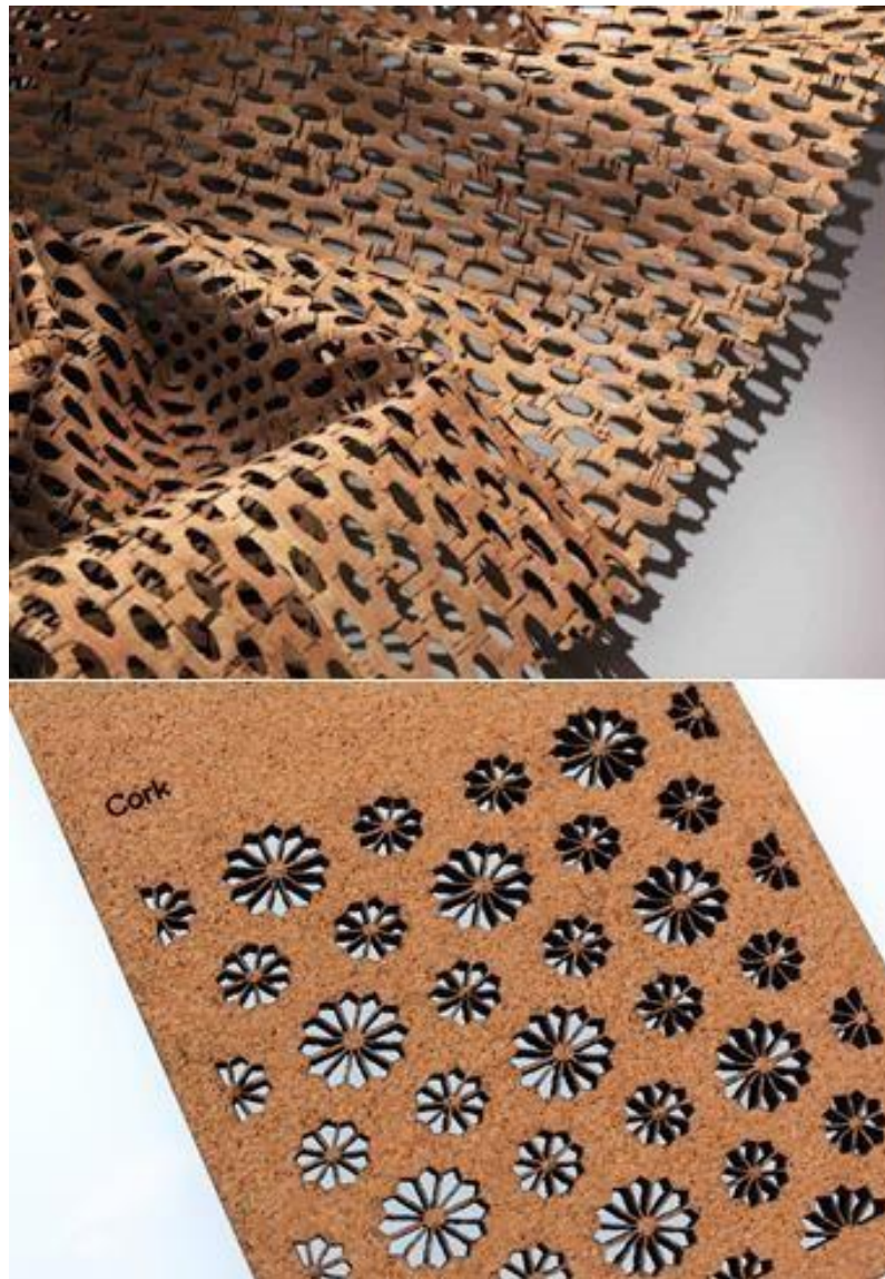
Figura 4.4 Un corte láser a través de paneles compuestos a base de corcho [11], [12].
